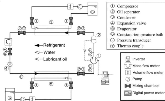
Abbildung 88: Experimenteller Aufbau (Fukuda et al., 2014).
