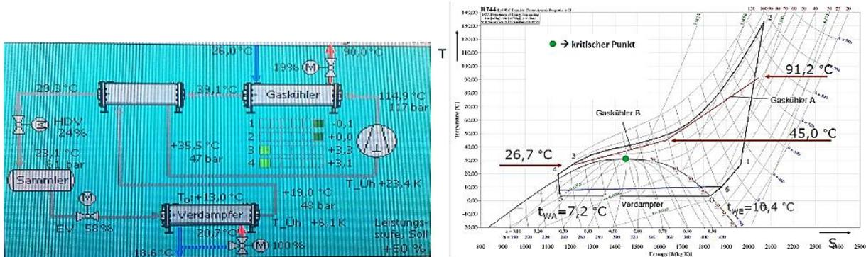
Abbildung 24: Schema und T-s Diagramm der CO<sub>2</sub> thermeco2 Wärmepumpe (Thermea, 2012).
