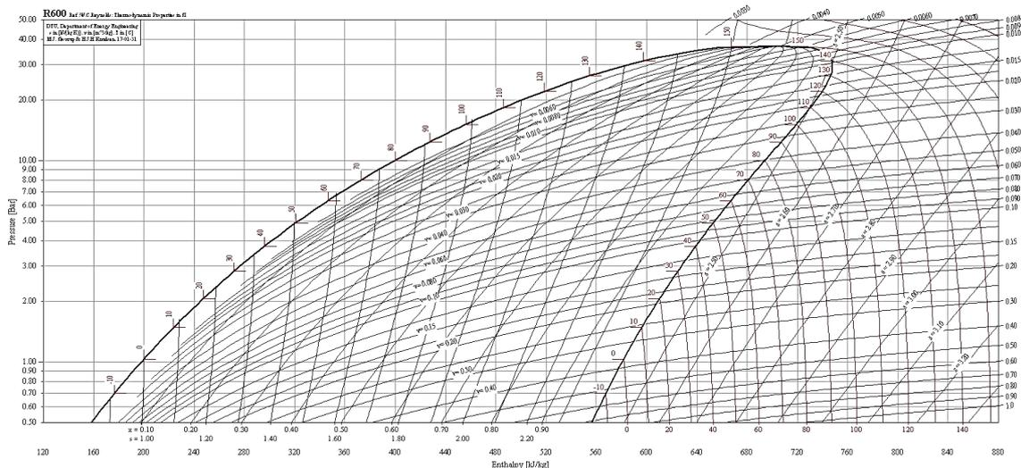
Abbildung 54: Log p-h Diagramm für n-Butan R600 (erstellt mit CoolPack Version 1.46).
