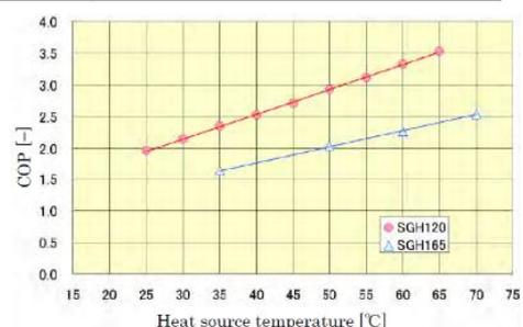
Abbildung 17: Die Wärmepumpendampferzeuger (Steam Glow Heat Pumps) SGH120 und SGH165 von Kobe Steel mit Doppelschraubenverdichter und technischen Leistungsdaten (IEA, 2014a; Kaida et al., 2015; Kuromaki, 2012; Watanabe, 2013).
