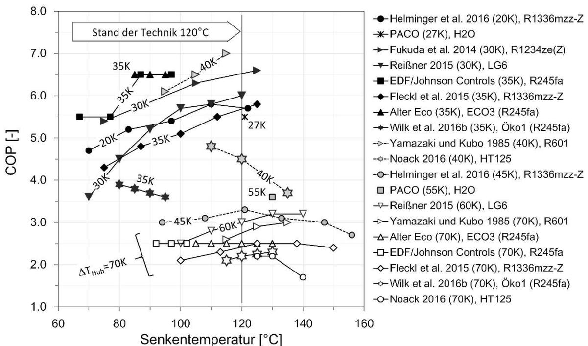
Abbildung 101: Experimentell erreichte COPs verschiedener Forschungsarbeiten von HTWP in Funktion der Senktemperatur bei unterschiedlichen Temperaturhüben von 20K bis 70K.
