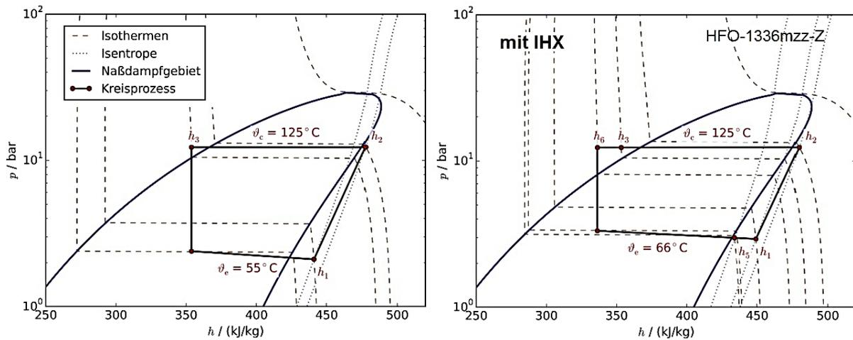
Abbildung 47: Log p-h Diagramme für HFO-1336mzz-Z des einfachen Wärmepumpenkreislaufs (links) mit internem Sauggasüberhitzer (IHX) (rechts). Die resultierende Flüssigkeitsunterkühlung beträgt für den einfachen Wärmepumpenkreislauf 8.5 bis 10.9°C und für den Wärmepumpenkreislauf mit IHX 6.5 bis 13.3°C (Helming et al., 2016).
