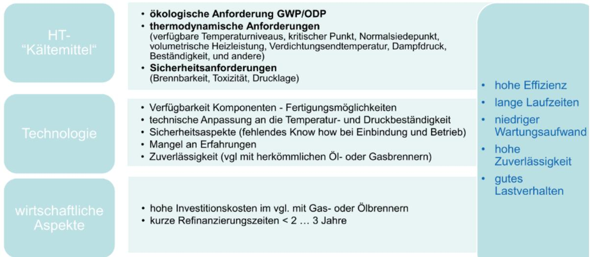
Abbildung 14: Anforderung für Hochtemperatur Wärmepumpen gemäss (Noack, 2016).
