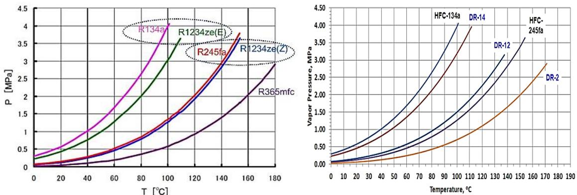
Abbildung 109: Dampfdruckkurven der Kältemittel R365mfc, R1234ze(Z), R245fa, R1234ze(E), DR-2, DR-12, DR-14 und R134a (Kontomaris, 2015; Watanabe, 2013).
