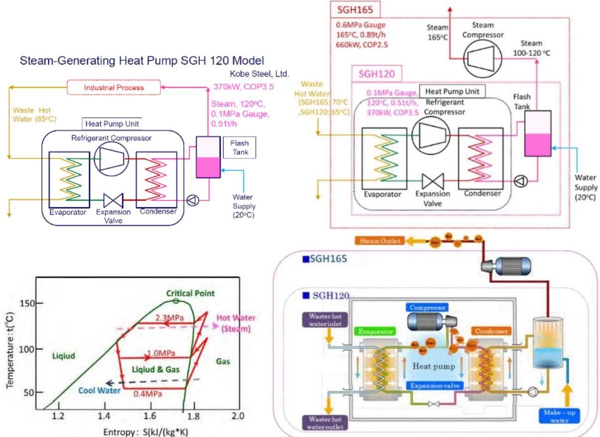
Abbildung 18: Schemata der Wärmepumpendampferzeuger SGH 120 und SGH165 mit Kältemittelmischung aus R245fa und R134a (Kobe Steel, Ltd.) (KOBELCO: SGH Series) (IEA, 2012; Watanabe, 2013), T-s Diagramm des 2-stufigen Kreislaufs mit HFC-245fa (IEA, 2014a).
