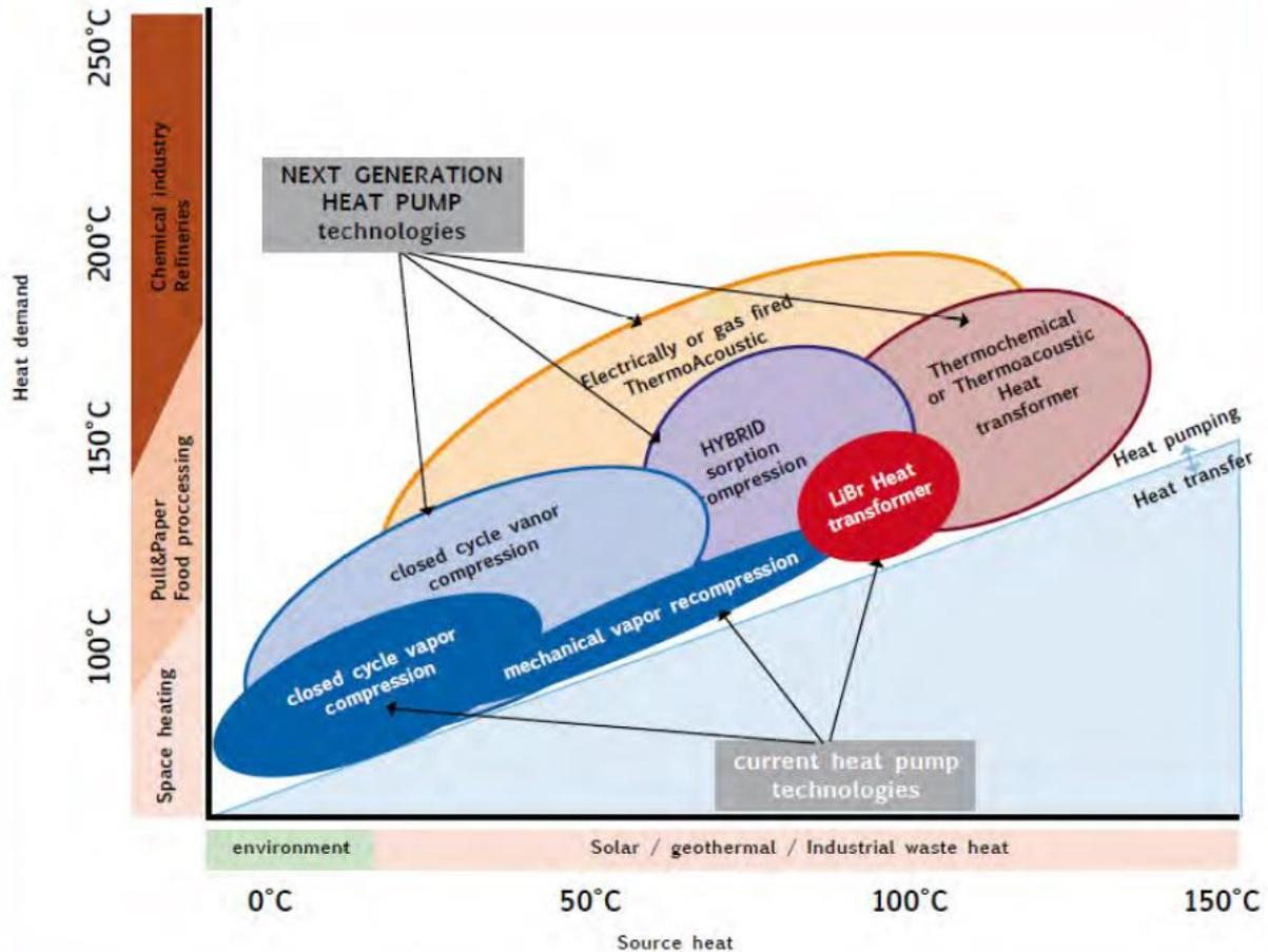
Abbildung 92: Wärmepumpentechnologien und deren Betriebstemperaturen (IEA, 2014a).
