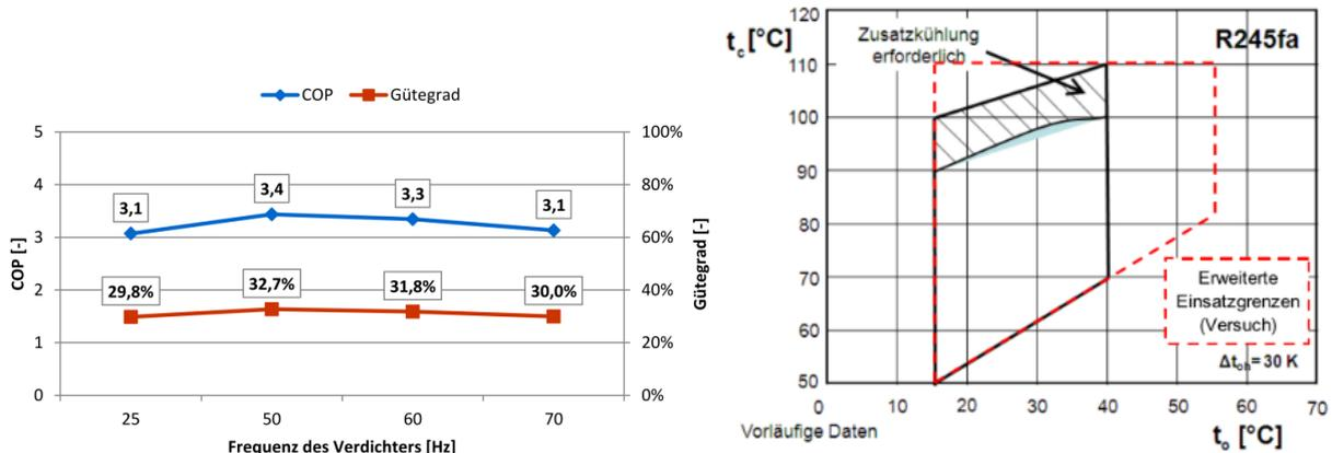
Abbildung 29: COP und Gütegrad der HTWP beim Betriebspunkt W50/W100 vs. Antriebsfrequenz des Verdichters (Jakobs and Laue, 2015; Wolf et al., 2014), Kennfeld des Kolbenverdichters (Wolf et al., 2014).
