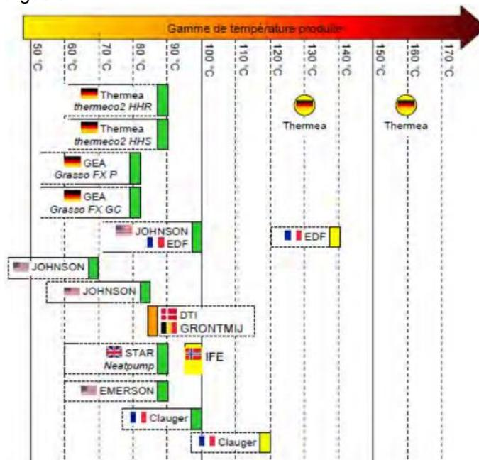
Abbildung 74: Erreichbare Temperaturen der Wärmepumpen Hersteller (IEA, 2014a).
