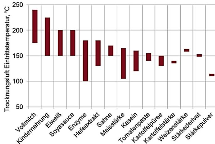
Abbildung 49: Trocknungstemperaturen verschiedener Lebensmittel (Wilk et al., 2016a).
