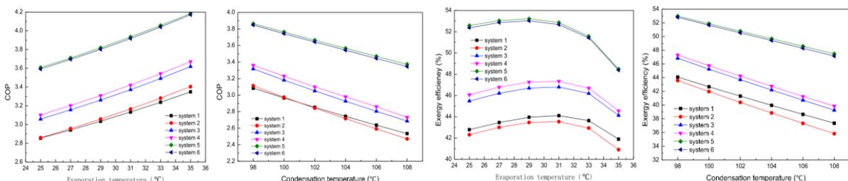
Abbildung 94: COP und Exergie Effizienz der untersuchten Kreisläufe in Funktion der Verdampfungs- und Kondensationstemperatur,  $T_{SH}:3^{\circ}C$ ,  $T_{SC}: 5^{\circ}C$ , Pinch Verdamer:  $5^{\circ}C$  (Cao et al., 2014).
