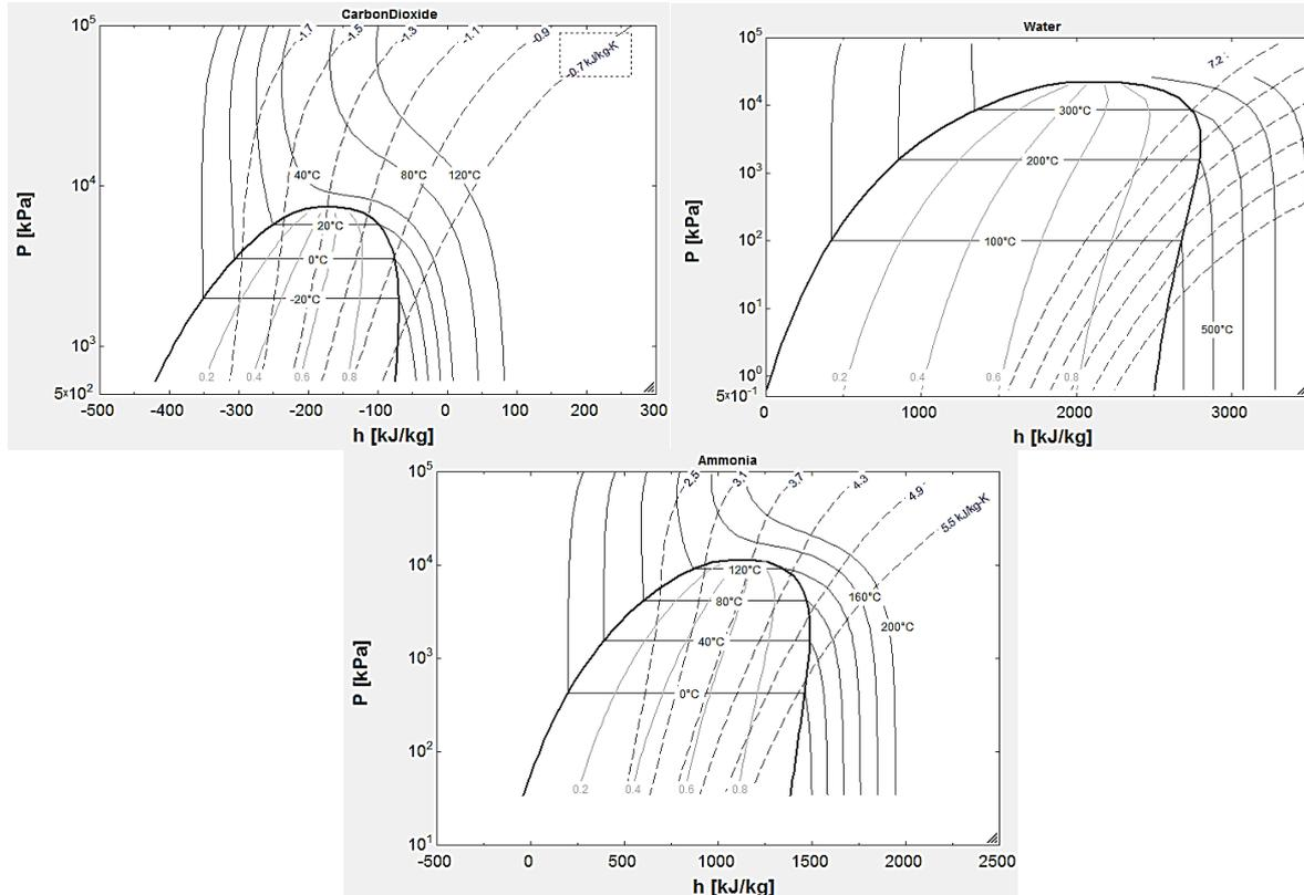
Abbildung 114: p-h Diagramm von R744 (CO<sub>2</sub>), R718 (Wasser) und R717 (NH<sub>3</sub>), Quelle: EES property plots.
