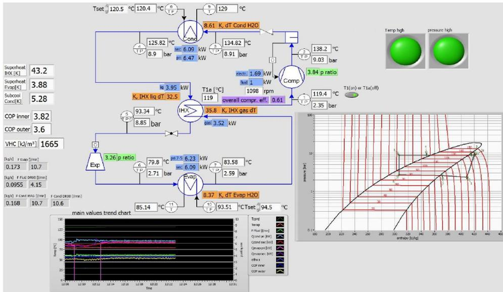
Abbildung 72: Labview Oberfläche der HTWP von (Reißner, 2015).
