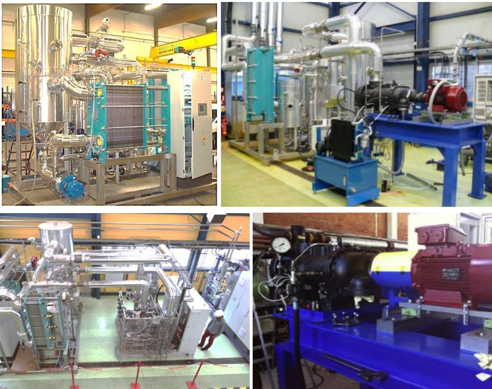
Abbildung 82: Schema und Fotos der Wasser (R718) HTWP des PACO Projekts mit Doppelschraubenverdichter (Chamoun et al., 2014, 2013, 2012b; EDF, 2015; IEA, 2014a).
