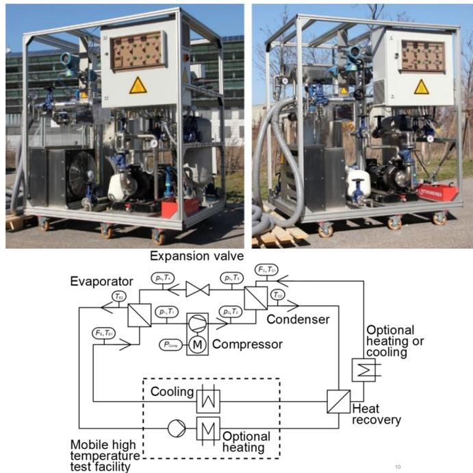
Abbildung 42: Mobile Hochtemperatur Wärmepumpe (Fleckl et al., 2015a).
