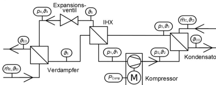
Abbildung 46 Wärmepumpenkreislauf mit Sauggasüberhitzung im IHX (Helminger et al., 2016).
