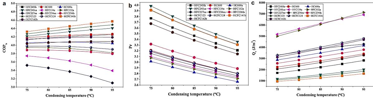
Abbildung 95: Theoretische Analyse verschiedener Kältemittel. COP [-], Druckverhältnis [-] und volumetrische Heizleistung [J/m<sup>3</sup>] in Funktion der Kondensationstemperatur, 1-stufiger Kreislauf, T<sub>SH</sub>: 5°C, T<sub>SC</sub>: 5°C, DT<sub>Hub</sub>: 45°C, eta<sub>isent</sub>: 0.95 (Pan et al., 2011).
