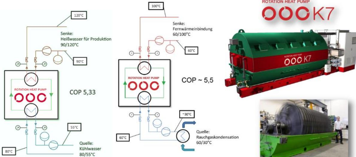
Abbildung 59: Aufbau und Schema der Rotationswärmepumpe K7 mit 700 kW Wärmeleistung (Alder, 2016) und Anwendungsbeispiele mit berechneter Leistungszahl (COP) ([www.ecop.at/de/produkt](http://www.ecop.at/de/produkt))
