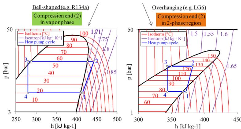
Abbildung 66: Überhängendes Nassdampfgebiet von LG6 (rechts) im Vergleich zu R-134a (links) (Reißner, 2015).
