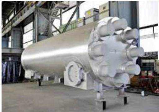
Mobiler Sorptionsspeicher für eine Verbrennungsanlage. 3.7 MWh Speicherkapazität, gemäss Kapitel 4.3 Quelle: [8]
