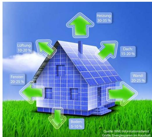
Abbildung 3: Typische Wärmeverluste eines Hauses
